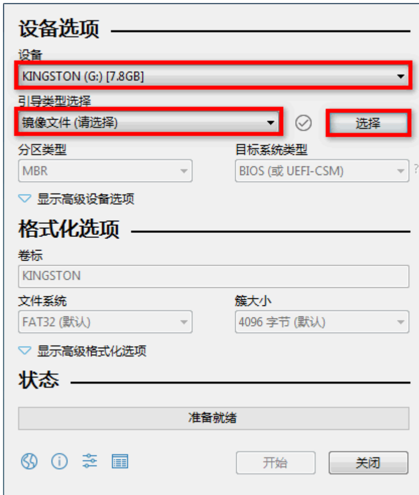
图7-1 选择设备、引导类型和 ISO 镜像
