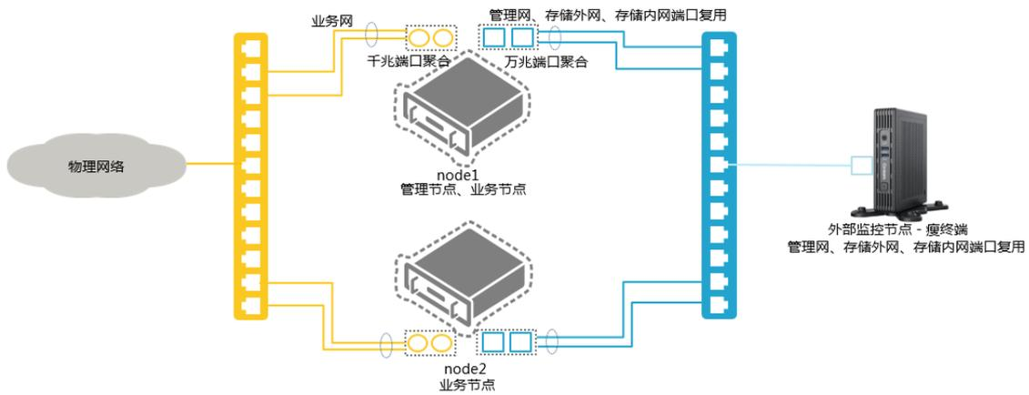
图3-6 两节点方案逻辑网络拓扑（虚拟机）
